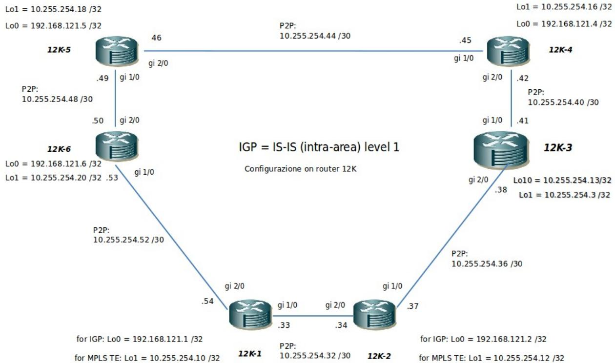
IS-IS è un protocollo IP routing di tipo CLNS (Connectionless Network Services) ed usa indirizzi CLNS per identificare i router e costruire la sua tabella di routing.
