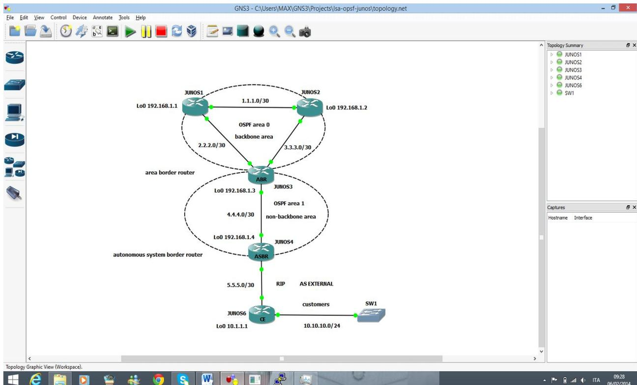
**LSA Type 1** è indicato come **ROUTER** (backbone router) ed è generato da tutti i router OSPF all'interno di una stessa area (intra-area) e descrive lo stato ed il costo dei link di connessione tra essi.
