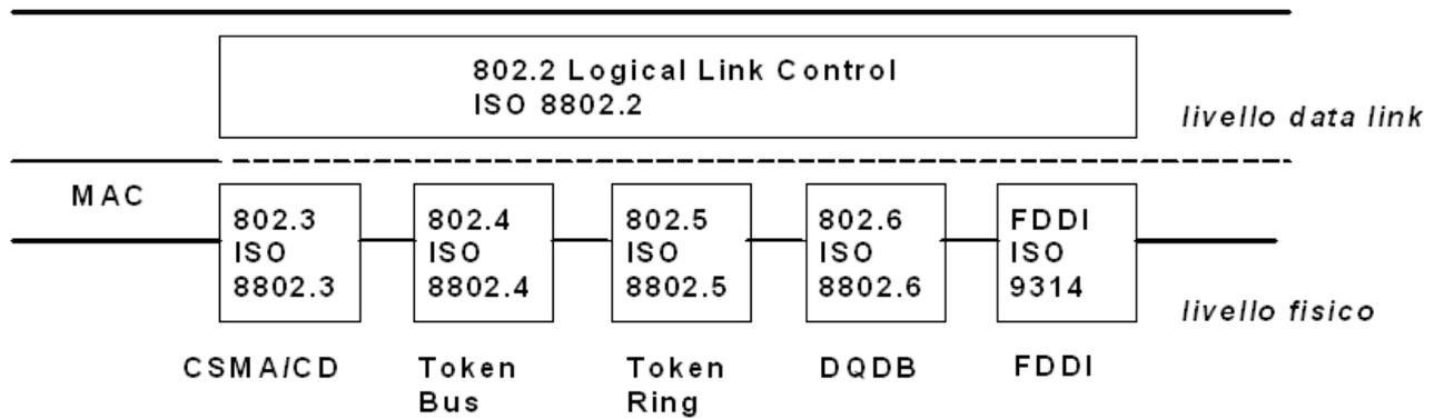
L'interconnessione tra le sottoreti DQDB all'interno di una MAN si può realizzare attraverso bridge (IEEE 802.6F-D5), router o gateway.
